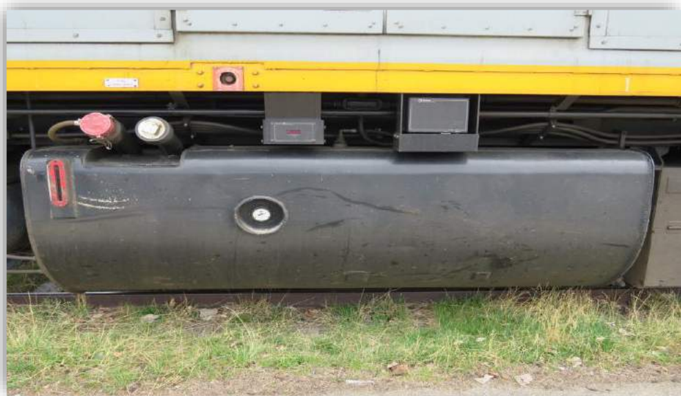
รูปที่ 10 ตัวอย่างถังน้ำมันเชื้อเพลิงบนรถไฟ
