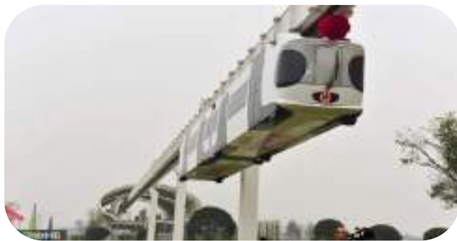
รูปที่ 6 : รถไฟฟ้าแบบแขวนพลังงานแบตเตอรี่ลิเธียมที่ทดสอบที่เมืองเฉิงตู
