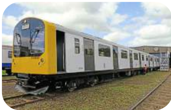
รูปที่ 10 : รถไฟพลังงานแบตเตอรี่รุ่น 230 ของบริษัท Vivarai
