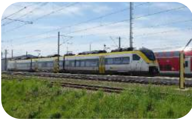
รูปที่ 13 : รถไฟพลังงานแบตเตอรี่รุ่น Siemens Mireo Plus B ที่ใช้ในประเทศเยอรมัน
