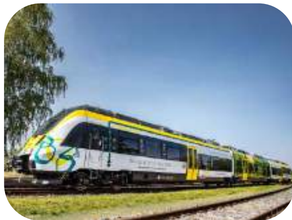
รูปที่ 14 : รถไฟฟ้า Talent 3 ที่ติดตั้งแบตเตอรี่เพิ่ม
