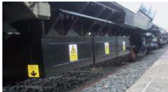
รูปที่ 1 : แผงแบตเตอรี่ที่ติดตั้งในรถไฟพลังงานแบตเตอรี่ ELECTROSTAR
