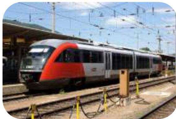
รูปที่ 12 : รถไฟพลังงานแบตเตอรี่รุ่น cityjet eco ที่ใช้ในประเทศออสเตรเลีย
