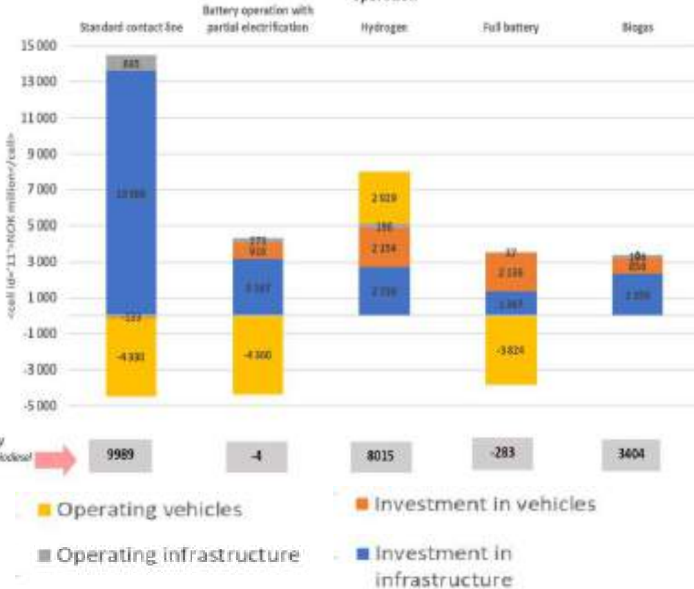
รูปที่ 5 : การเปรียบเทียบการลงทุนการปรับเปลี่ยนระบบจ่ายพลังงานรถไฟในสาย Nordland ประเทศนอร์เวย์
